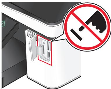
**Achtung — Mögliche Schäden:** Kabel, Netzwerkadapter, Anschlüsse, USB-Bluetooth-Adapter oder Drucker in den angezeigten Bereichen dürfen während eines Druck-, Lese- oder Schreibvorgangs mittels eines Bluetooth-fähigen Geräts nicht berührt werden. Daten können verloren gehen.
