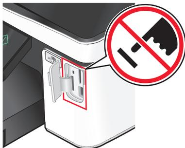
**Achtung — Mögliche Schäden:** Kabel, Netzwerkadapter, Anschlüsse, Speichermedium oder Drucker sollten im angezeigten Bereich während eines Druck-, Lese- oder Schreibvorgangs mittels Speichermedium nicht berührt werden. Daten können verloren gehen.
